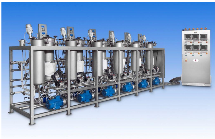
2-rasm. Takomillashtirilgan ko‘p komponentli dozatorli bo‘yoq tayyorlash qurilmasining umumiy ko‘rinishi.
