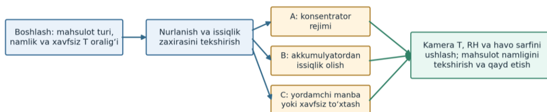
2-rasm. Nurlanish va issiqlik zaxirasiga qarab rejim tanlashning prinsipial ketma-ketligi (konseptual tasvir).
